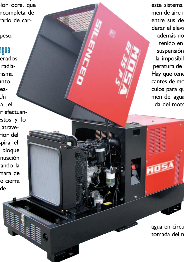
Grupo Electrónico MOSA modelo GE-35 PS de 33 kVA, con motor diésel PERKINS a 1500 rpm y refrigeración por agua.
