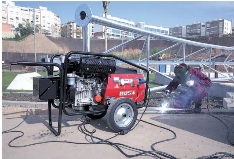
especial para soldadura, como en el caso de MOSA, o de un alternador síncrono más adecuado para la generación de energía y arranque de motores, y nada adecuado para la soldadura.
